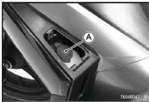
A. Bouchon du réservoir
