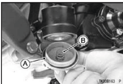
A. Joint torique B. Ressort
